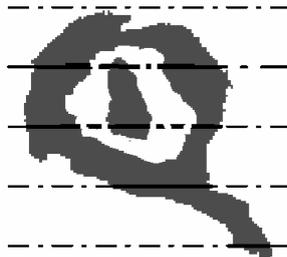
Рис. 5.13. Наложение сетки горизонтального интерцепта (пунктирные линии) и горизонтальные хорды (прямые линии)
