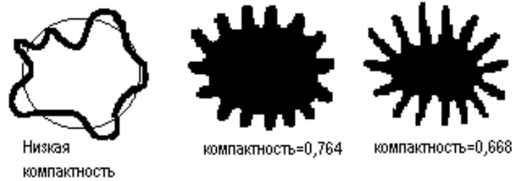
Рис. 5.6. Объекты с разной компактностью
